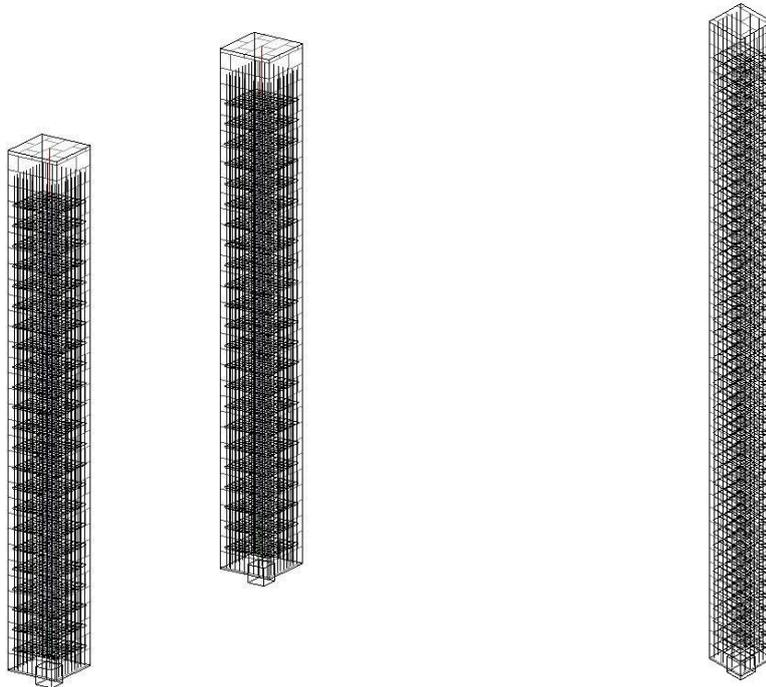
Figura 75. Armadura pilares oficinas
