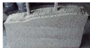
Aspecto, textura y acabado del conglomerado de fibras de cáñamo Hempcrete.
