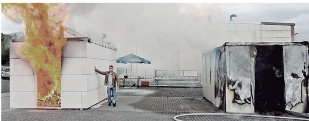
Pruebas contra incendios bloques de hormigón celular
