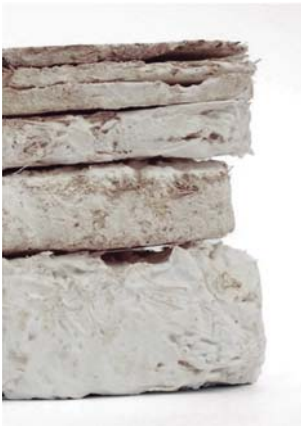
Compuesto de micelio con añadidos agrícolas cocido y deshidratado.
