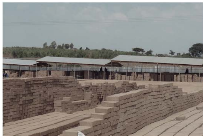
Proceso de fraguado de los ladrillos
