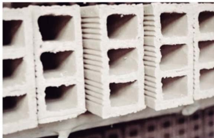
Ladrillos fabricados con lodos. Fuente: Xavier Elias (4 de abril de 2016) "Valorización de subproductos en la gestión municipal". Facultad de Ingeniería – Universidad Nacional de La Plata
