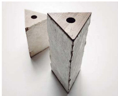
Encofrado del compuesto de Micelio, y bloques resultantes posibles.
