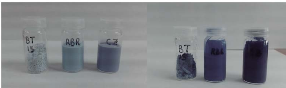
Tonalidades adquiridas por el cemento termocrómico
