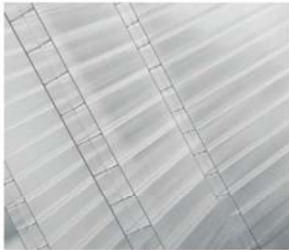
Policarbonato celular, Fuente: FlyerOne (4 de junio de 2018) Artículo sobre el Aerogel. http://flyerone09.blogspot.com/2009/10/aerogel-un-nuevo-material-de-altas.html
