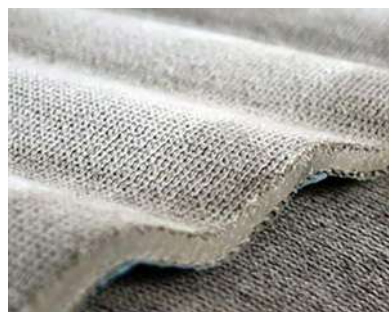
Figura 289. Detalle del material Concrete Canvas
