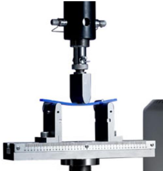
Figura 12. Ensayo de flexión a 3 puntos. (Instron, s. f.)
