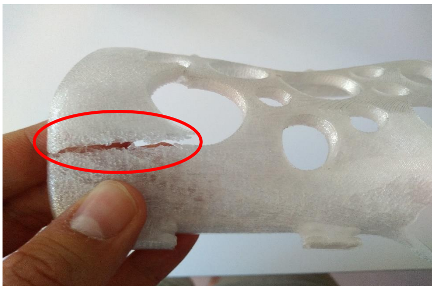
Figura 39. Zona de rotura de la férula
