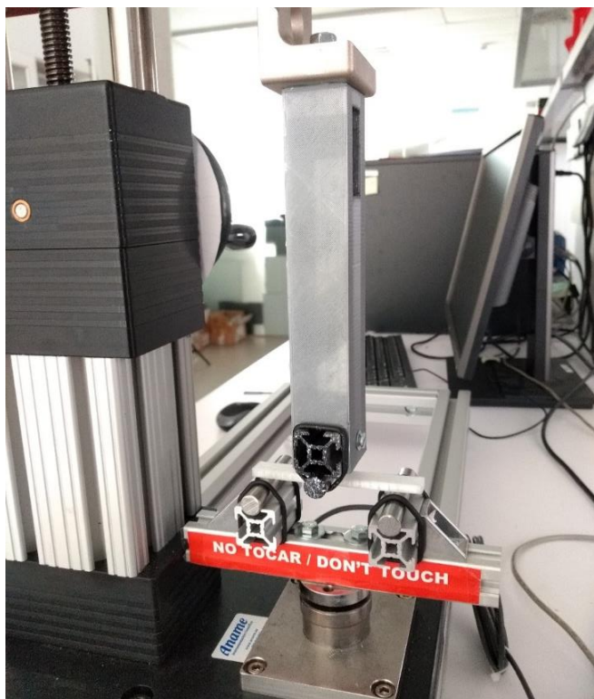
Figura 30. Montaje del utillaje para el ensayo a flexión
