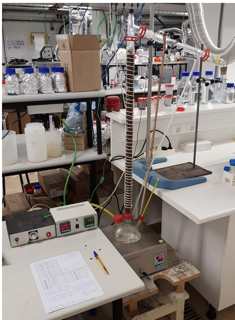
Ilustración 17. Set-up de Steam Distillation.
