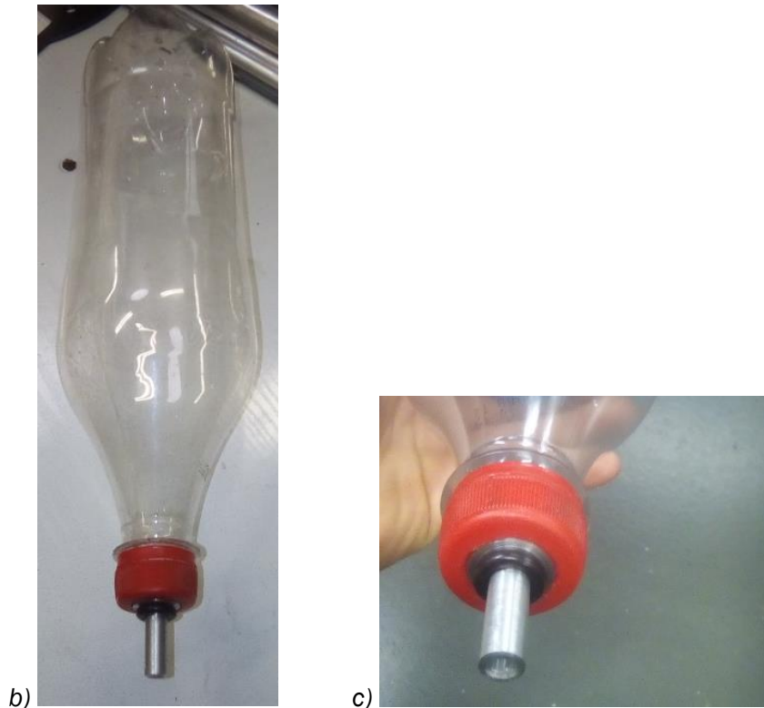
Figura 74. a) Acople tapón-tobera; b) Cohete; c) Acople de junta tórica en cohete.
