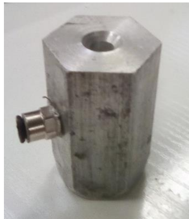
Figura 67. Alojamiento para la tobera en pieza M132.
