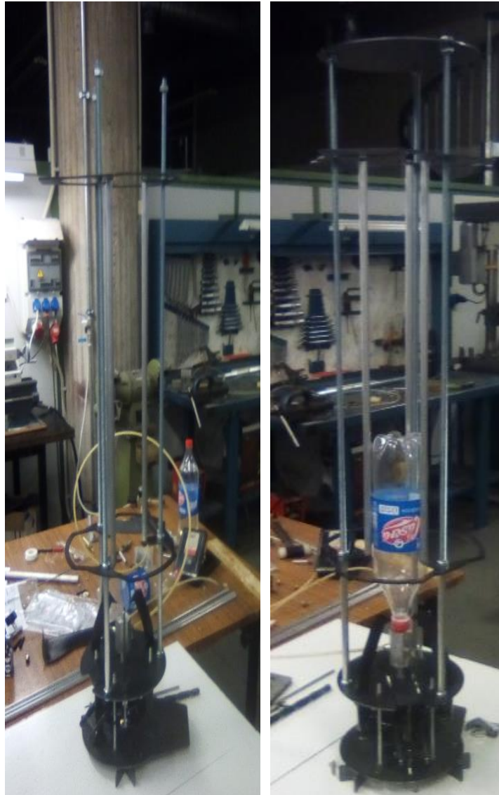
Figura 82. Lanzadera montada y acoplada a instalación neumática.
