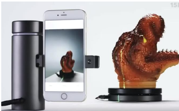
Ilustración 16: Modelo 3D de una cabeza de dinosaurio mediante Eora 3D y su escaneado 3D.
