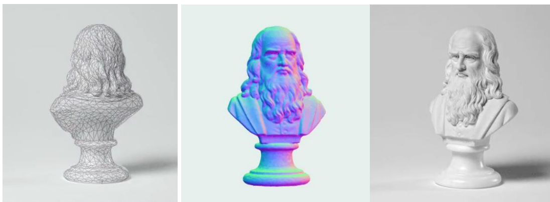
Ilustración 5: Objeto escaneado y modelo 3D de una estatua mediante Matter and Form
