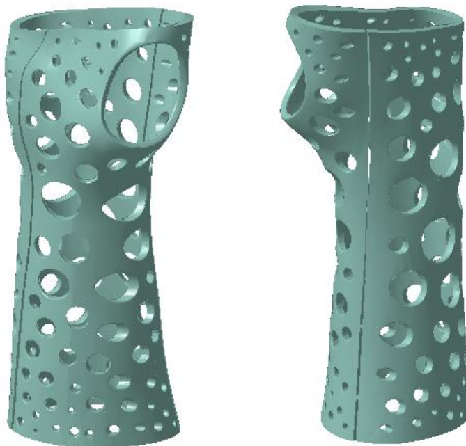
Ilustración 100: Férula final diseñada en Catia.
