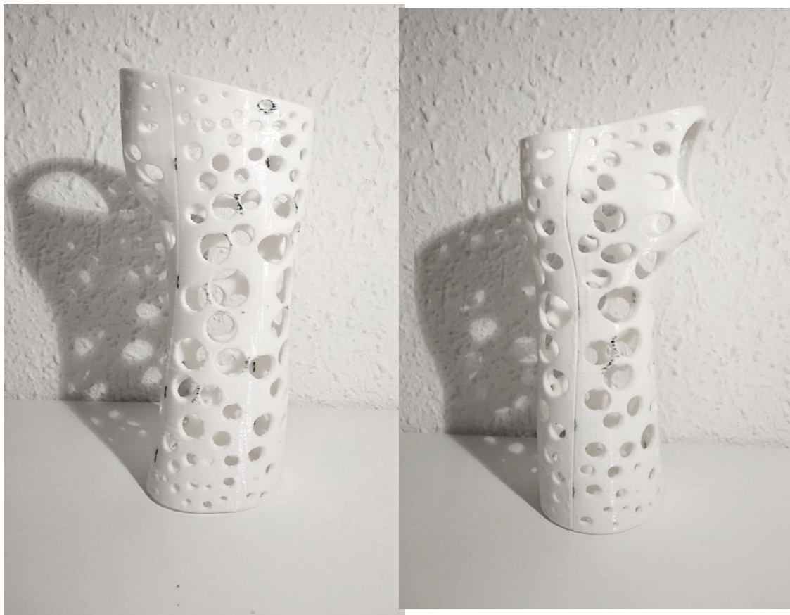
Ilustración 112: Primer prototipo de férula Skone
