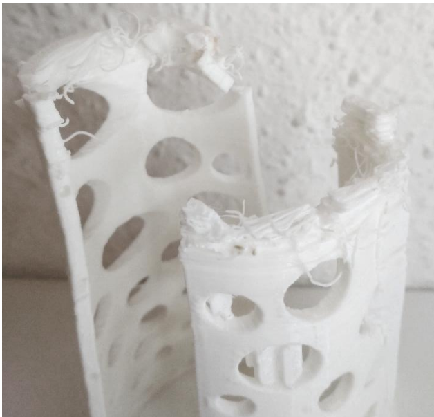
Ilustración 115: Detalle de la impresión fallida. Elaboración propia.
