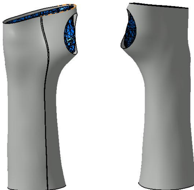
Ilustración 92: Modelo 3D de férula con superficies
