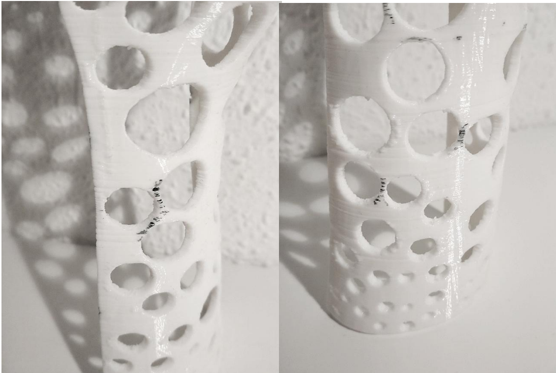
Ilustración 114: Detalle de los agujeros e imperfecciones de férula Skone
