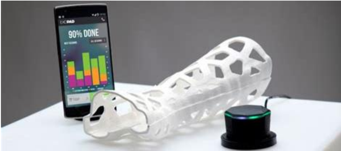
Ilustración 31: Férula impresa en 3D y electroestimulador de Exovite
