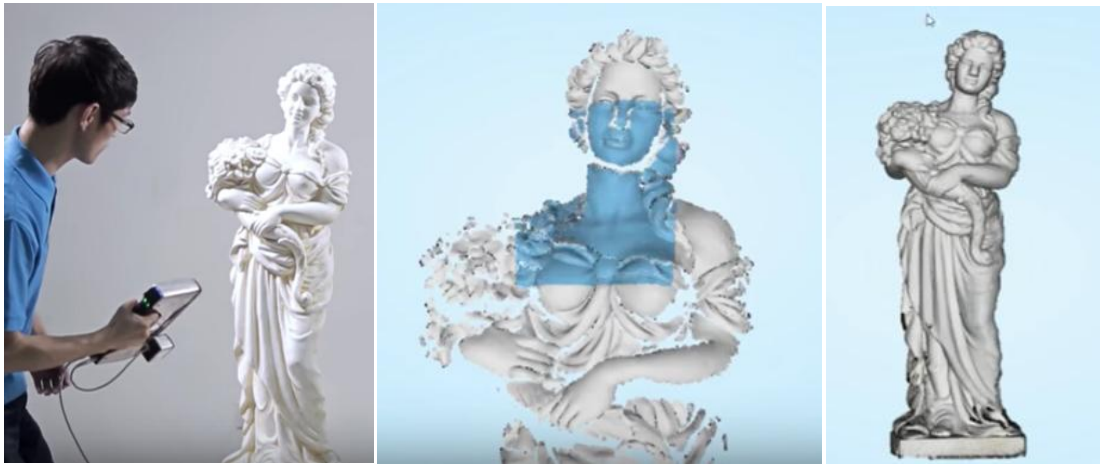
Ilustración 9: Escaneado 3D y modelo 3D de una estatua mediante Einscan-Pro
