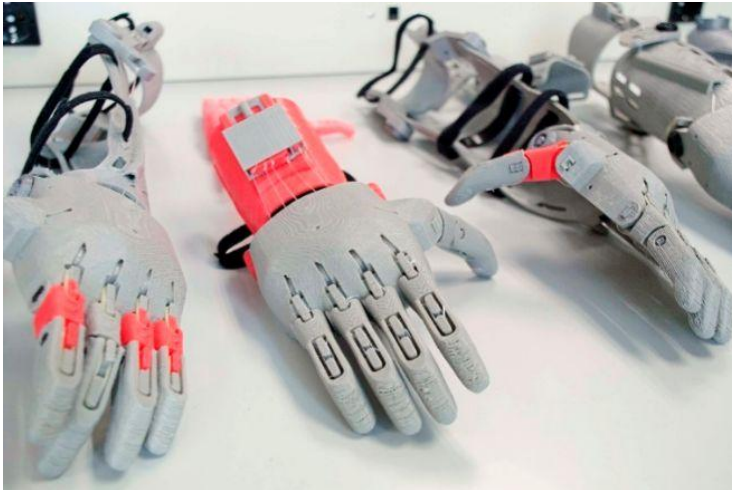
Ilustración 27: Prótesis de miembro superior impresas en 3D por Guillermo Martínez
