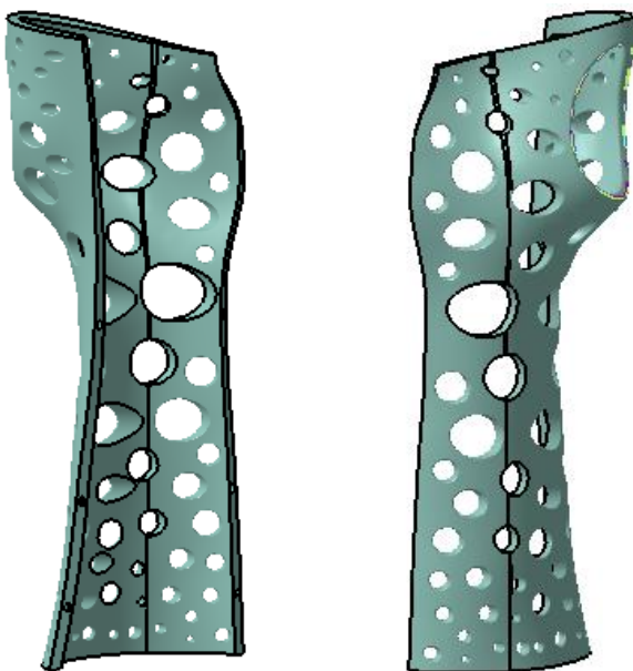
Ilustración 98: Parte 1 y 2 de férula con sistema de unión
