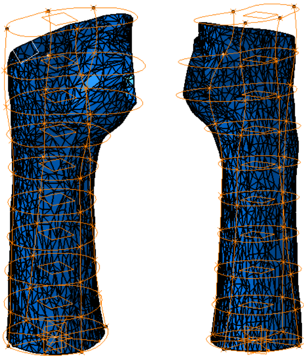
Ilustración 91: Diseño para la elaboración de la superficie de la férula
