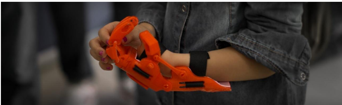
Ilustración 28: Prótesis de mano impreso en 3D para un niño de Atomic Lab
