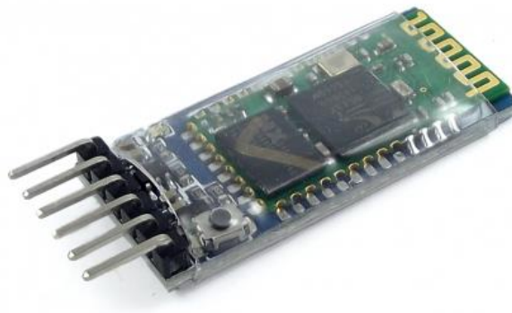
Figura 51. Módulo Bluetooth HC-05.
