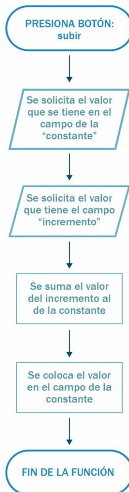
Figura 82. Diagrama de flujo del botón “Subir”.
