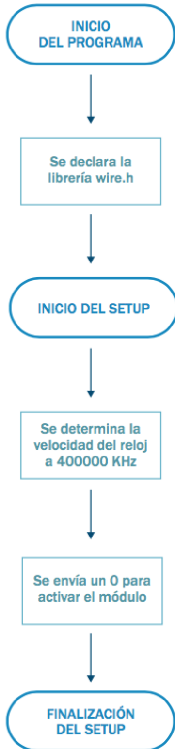
Figura 68. Inicialización de comunicación I2C.
