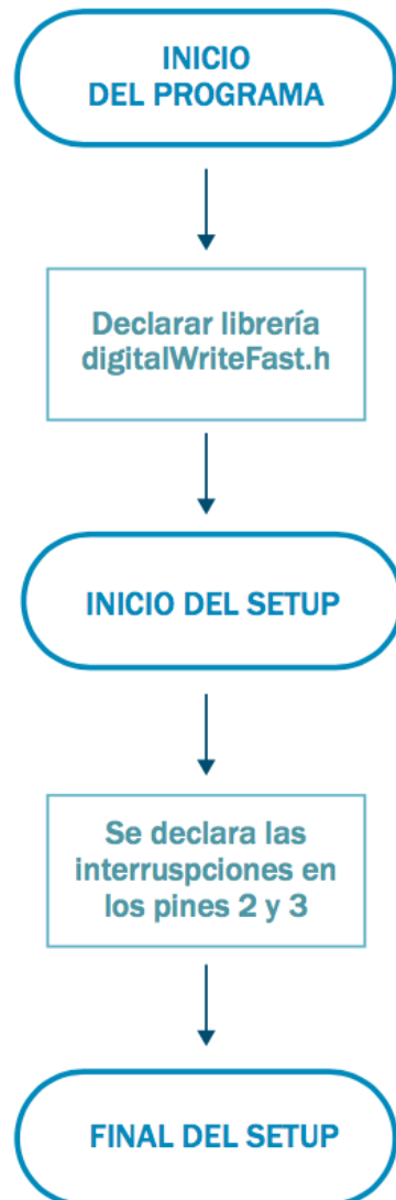
Figura 64. Inicialización de todo lo necesario para obtener la velocidad.
