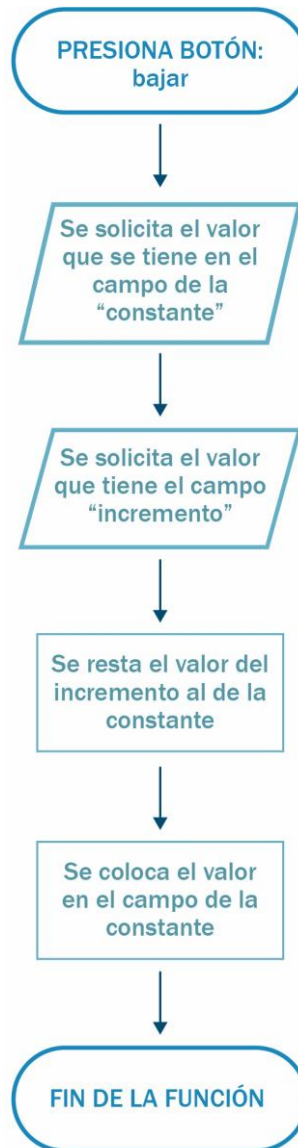
Figura 83. Diagrama de flujo del botón “Bajar”.
