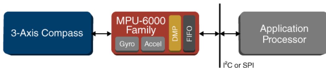
Figura 49. Diagrama de funcionamiento de MPU 6050.
