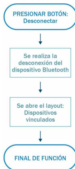
Figura 86. Diagrama de flujo de botón "Desconectar".
