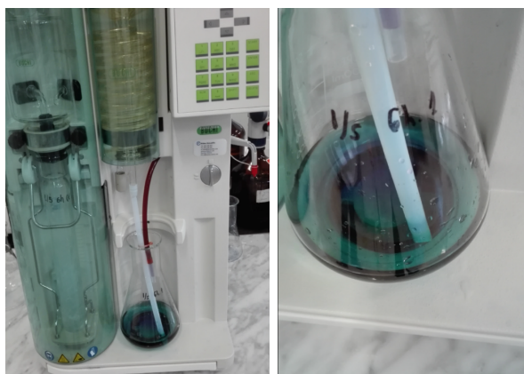
Figura 24 - Equipo Buchi kjelflex k-360 tras un proceso de predestilado y destilado. Dónde el color morado brillante, característico del boro, se tiñe a azulado verdoso tras añadir al Erlenmeyer el condensado de la muestra destilada.
