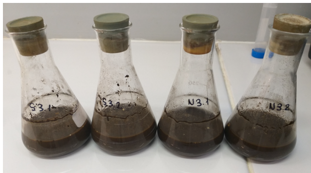
Figura 21 – Fracción sólida y extracto líquido mezclados en el matraz tras la extracción ácida.
