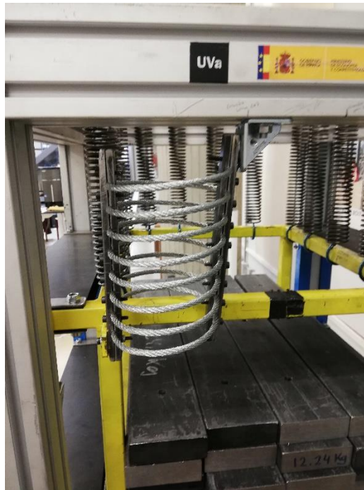
Figura 3. 29: Colocación bobina de cables metálicos 6x7
