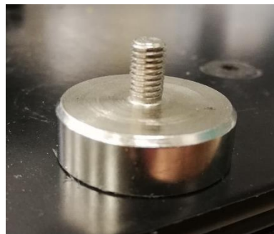
Figura 3. 9: Imán para la colocación de los acelerómetros.
