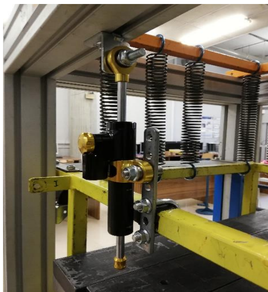
Figura 3. 35: Colocación del Steering Damper en el TMD.
