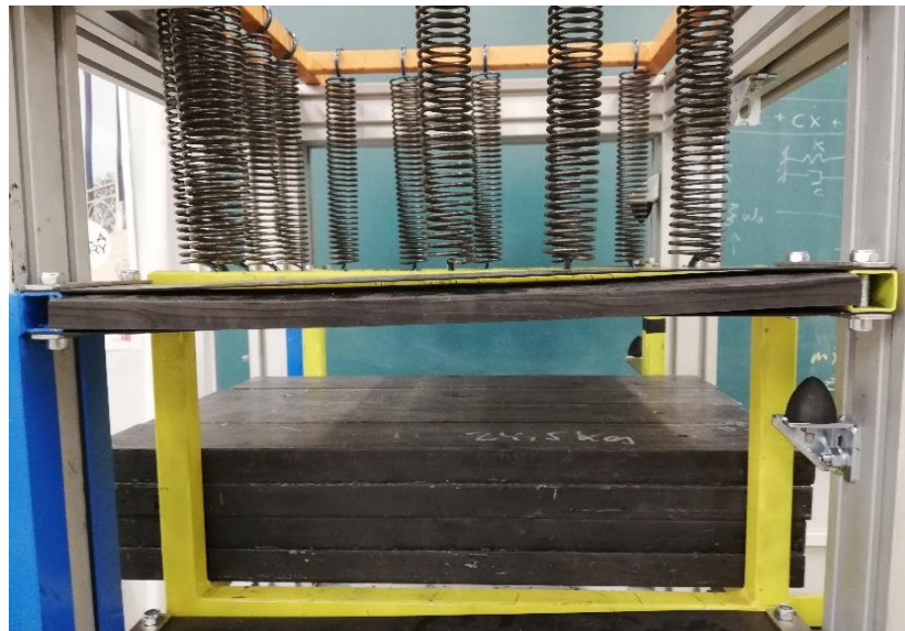
Figura 6. 1: Lámina de neopreno colocada entre las ballestas.
