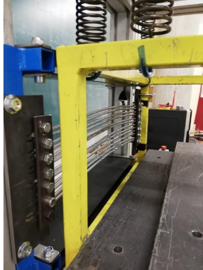
Figura 3. 31: Colocación de la batería de cables 1x19.
