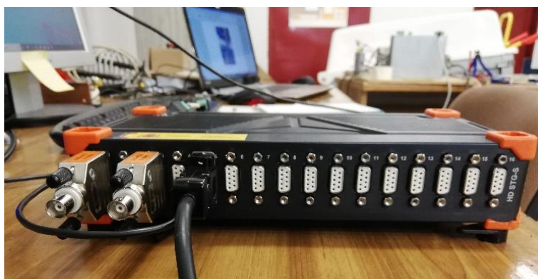
Figura 3. 19: Conexión de los acelerómetros y el sensor láser.
