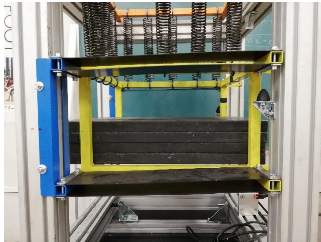
Figura 3. 7: Colocación de las ballestas.
