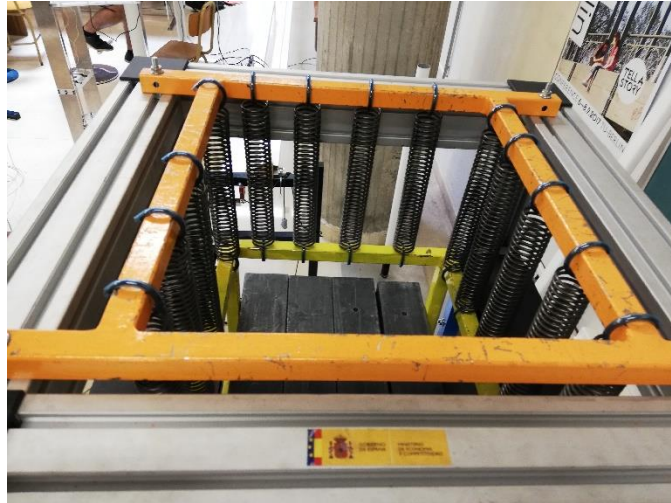
Figura 3. 6: Colocación de los muelles.
