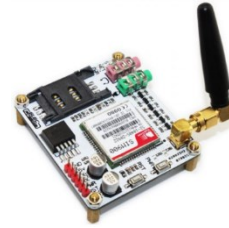
Fotografía 26. Módulo GPRS para Arduino
