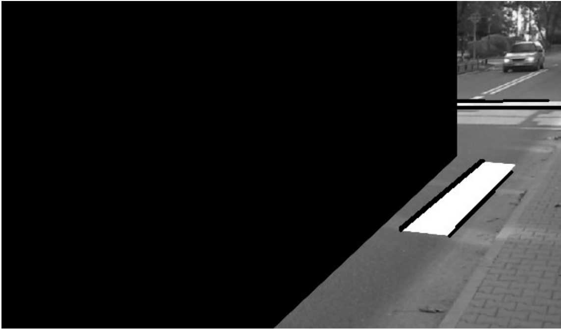
Ilustración 9. Ejemplo 2. Líneas detectadas por la función HoughLinesP
