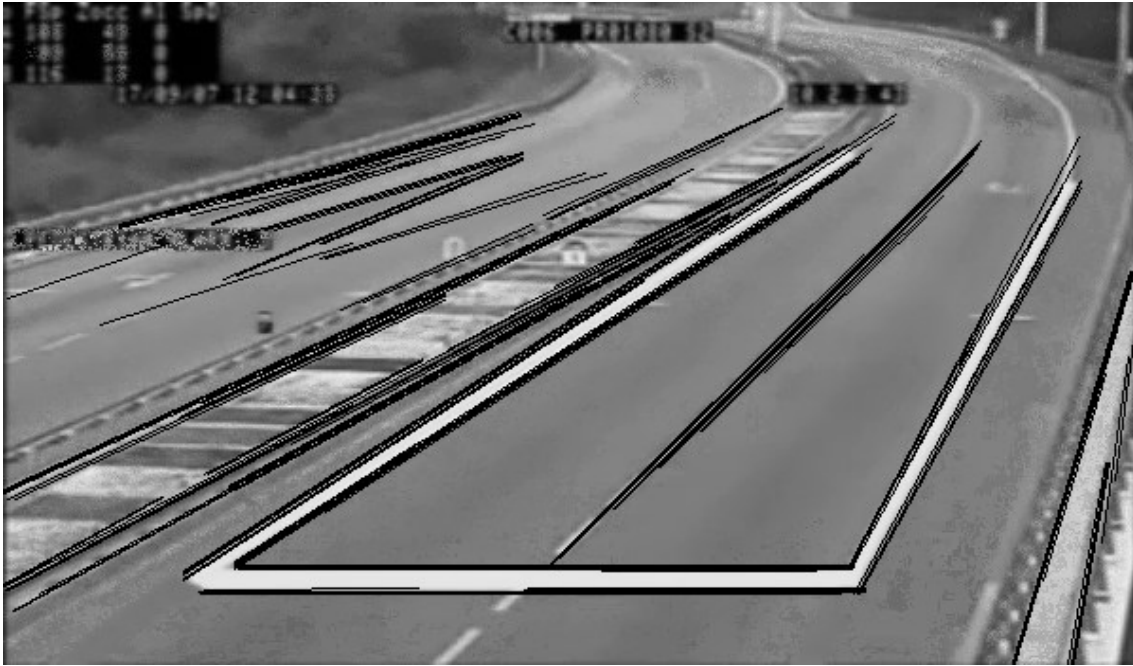
Ilustración 2. Líneas detectadas por la función HoughLinesP
