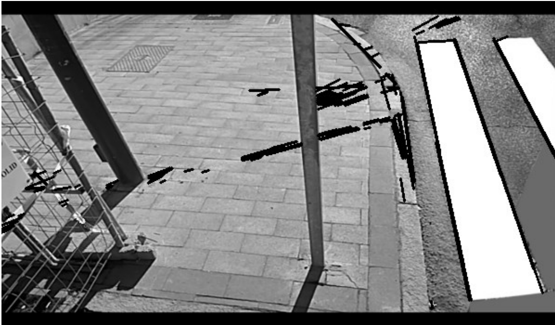
Ilustración 54. Líneas obtenidas por la función HoughLinesP
