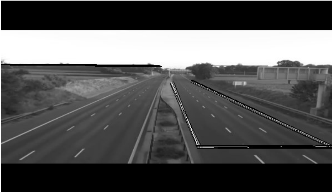
Ilustración 40. Líneas detectas por la función HoughLinesP
