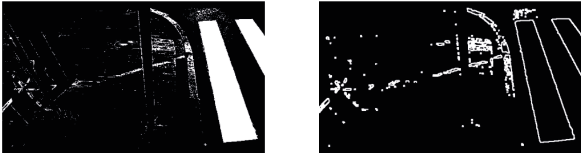
Ilustración 53. Segmentación por color blanco (izquierda). Contornos imagen segmentada (derecha)
