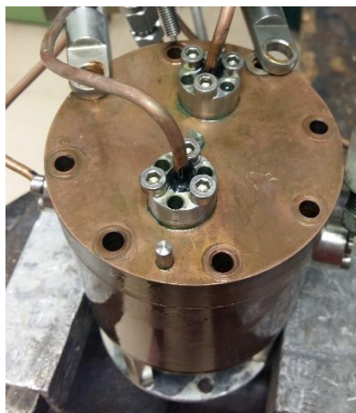
Figura 11. Cavidad cilíndrica de microondas sin uno de los platos de acero y sin los separadores.
