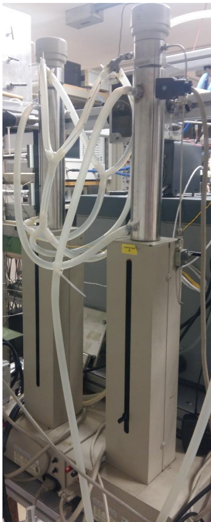
Figura 14. Bomba A (izquierda) y bomba B (derecha), de tipo jeringa ISCO 260D.
