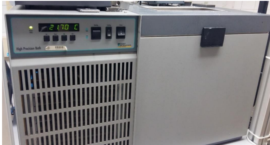
Figura 15. Baño termostático Fluke modelo 7037.
