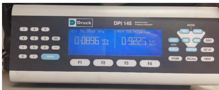
Figura 19. Indicador multifuncional Druck DPI 145.
