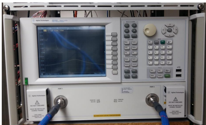
Figura 16. Analizador vectorial de redes (VNA) PNL N5230C Agilent Technologies.
