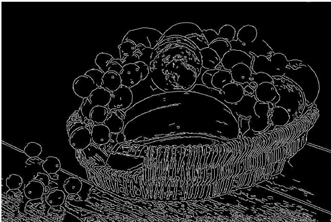
Ilustración 19 - Aplicación filtro Canny para extraer contornos [14].
