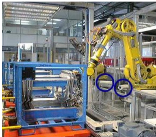
Ilustración 34 - Ejemplo sistema de pick-up & place [21].
