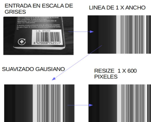
Ilustración 37 - Ejemplo sistema de clasificación [21].
