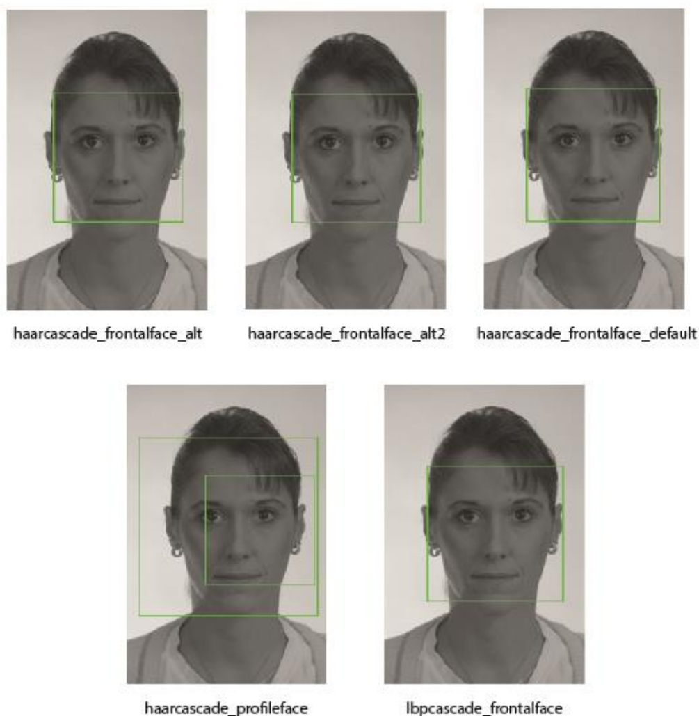
Ilustración 56 - Muestra descriptores HaarCascade.
