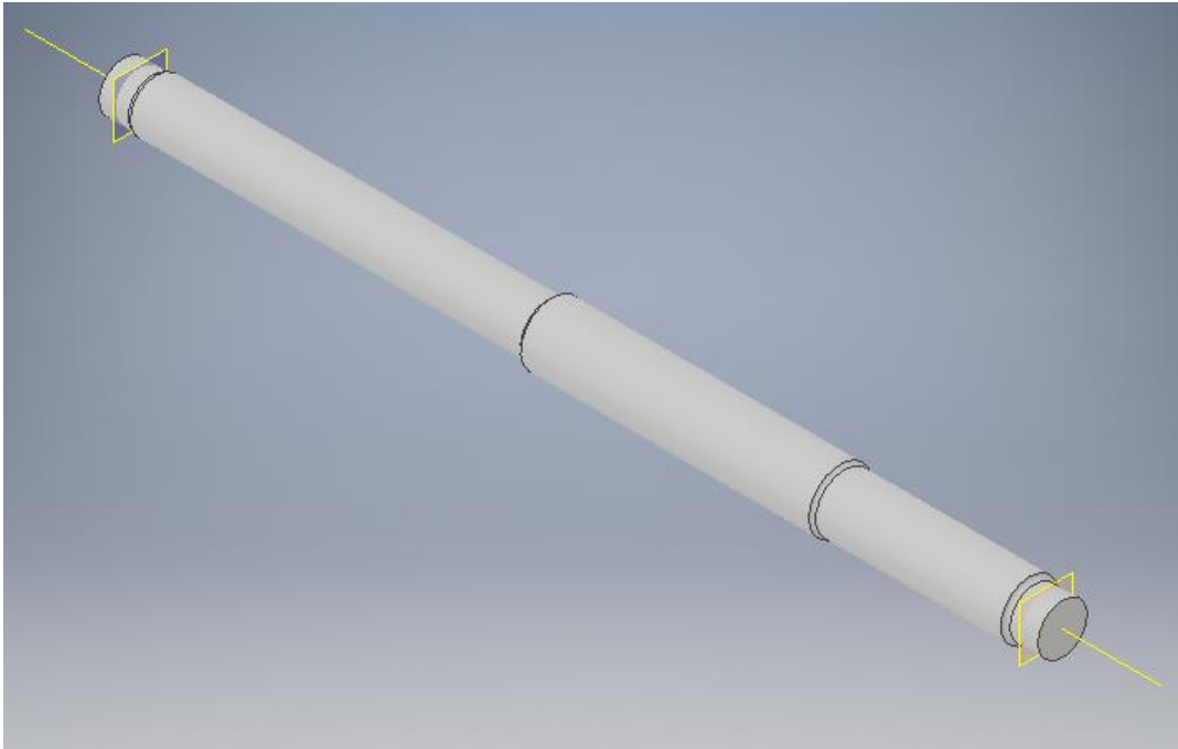
Figura 4.12. Vista del eje con los planos auxiliares correspondientes a los apoyos
