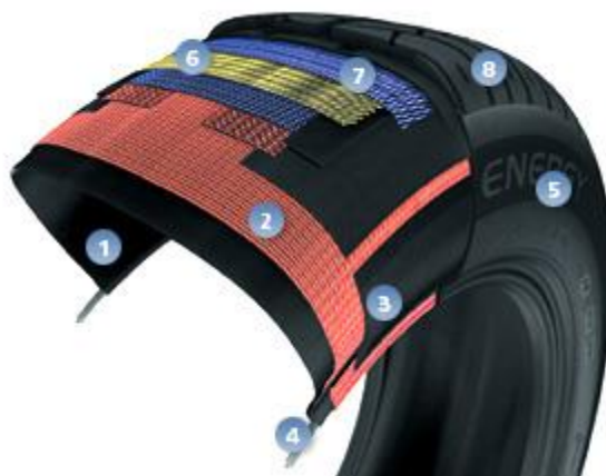
Imagen 1: Partes básicas de un neumático.
