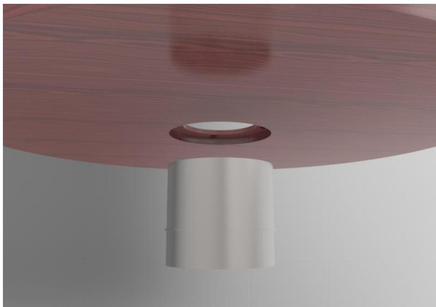
Figura 6.1.2 Encaje a presión del refuerzo interior de acero al tablero.
