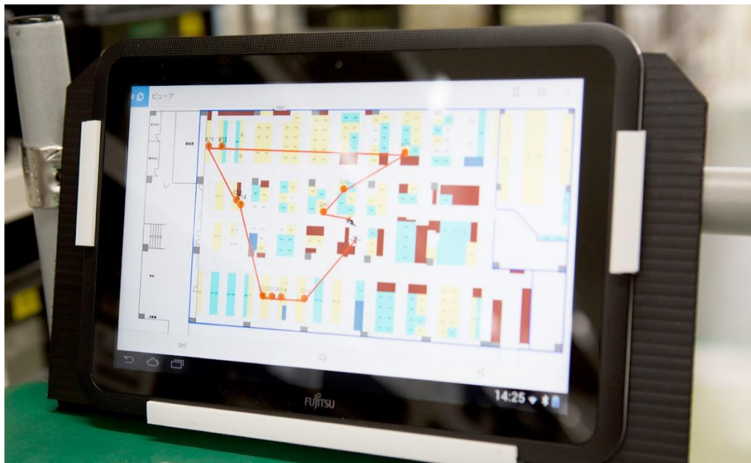
Figura 4.2 Una tableta muestra la ruta óptima de recogida de piezas en un mapa del almacén. Fuente: (Fujitsu, s.f.)
