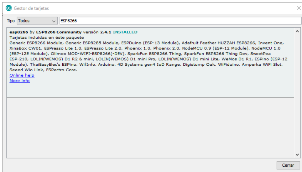
Ilustración 47. Añadir ESP8266 en el gestor de tarjetas Arduino.
