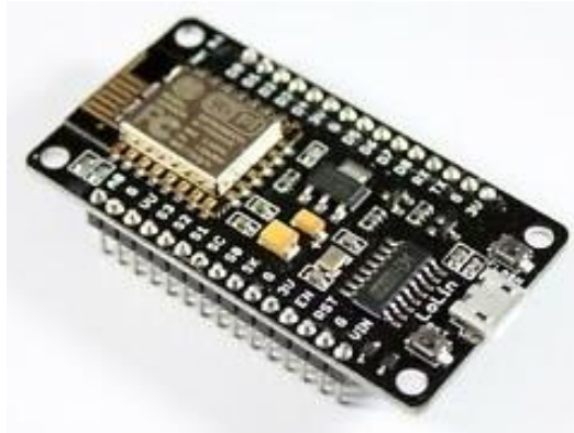
Ilustración 24. Placa de desarrollo NodeMCU.
