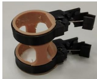
Figura 26. Pieza anillo fabricada por impresión 3D.
