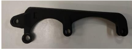
Figura 25. Pieza intermedia fabricada por impresión 3D.
