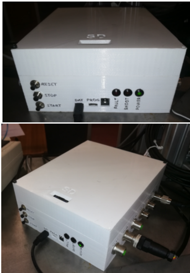
Figura 3.20. Diferentes vistas de la caja de control.
