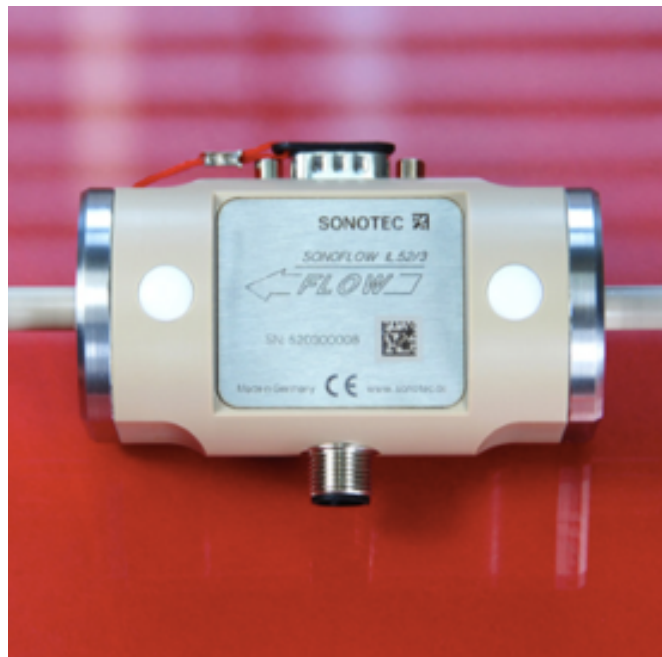
Figura 3.17. Imágen del caudalímetro
