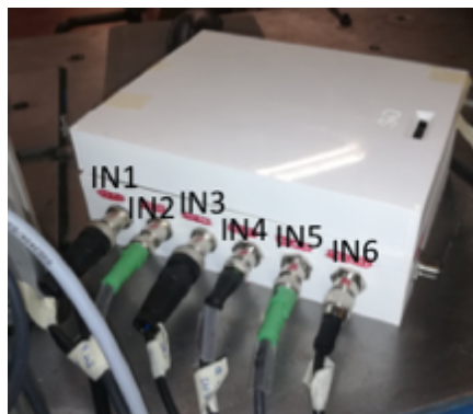
Figura 4.4. Imagen de la caja de control en la que se indican las entradas que tiene.
