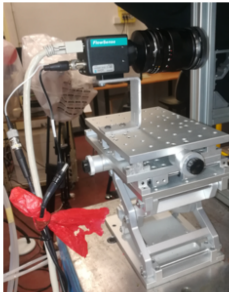
Figura 4.3. Cámara digital montada sobre la estructura metálica.
