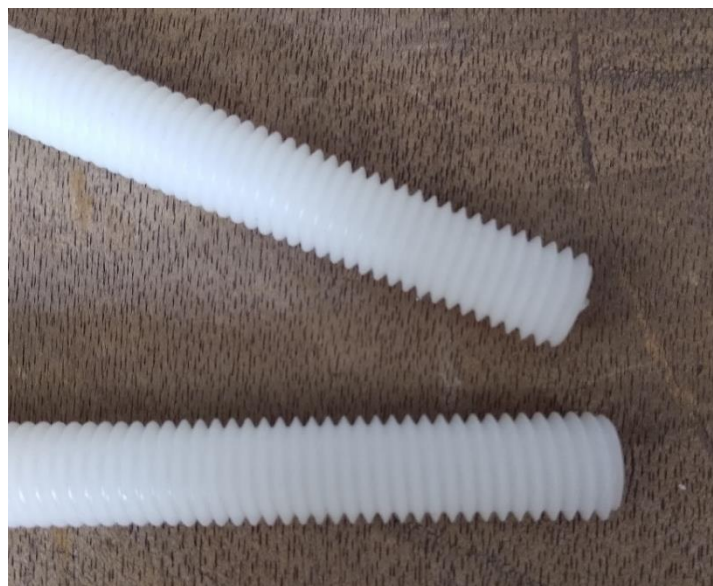
Figura 10. Varillas de nailon roscadas.
