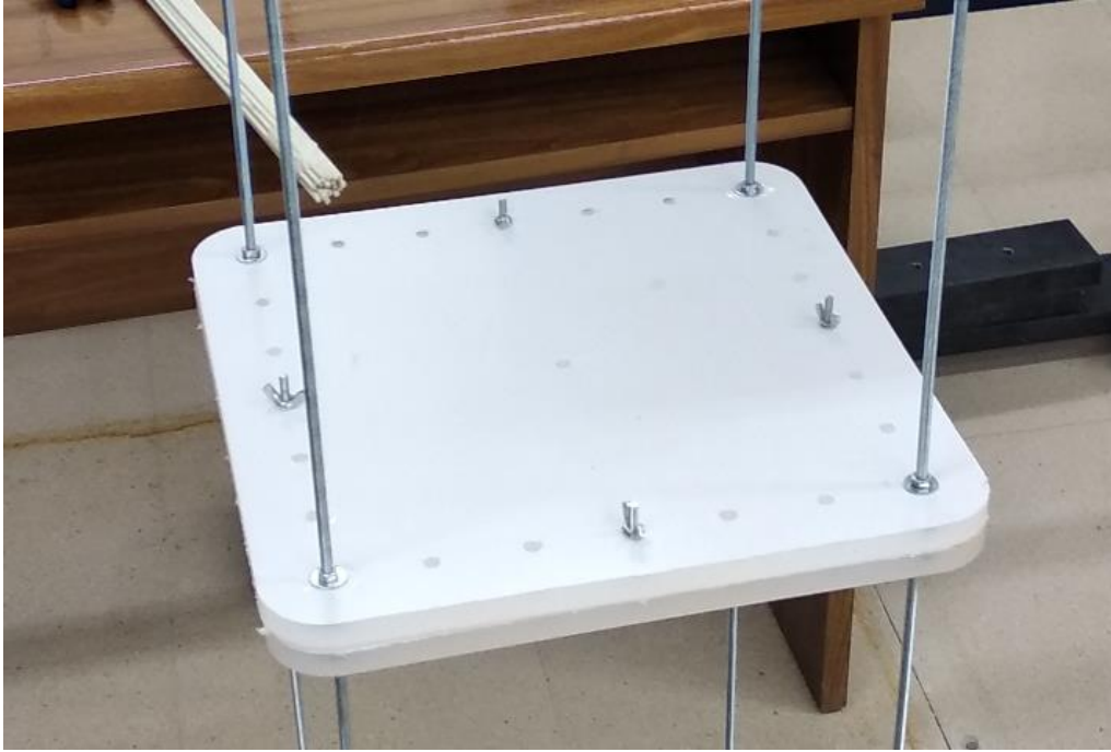
Figura 19. Unión entre módulos.
