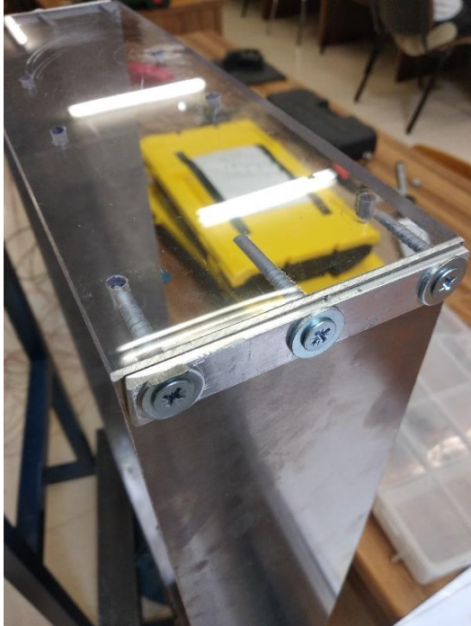
Figura 2. Unión entre pletina, lámina y placa de metacrilato.
