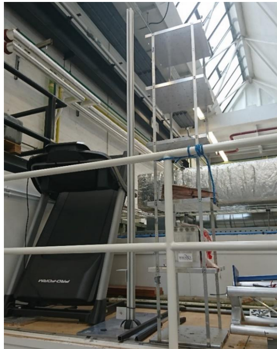
Figura 5. Estructura con pilares de lámina de aluminio.
