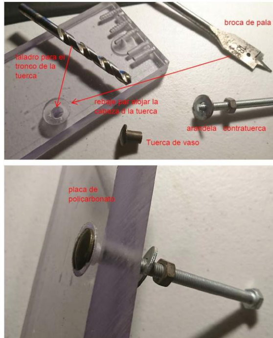
Figura 14. Prueba de montaje de la unión.
