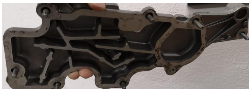
Figura 3 Cámara de estabilización
