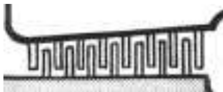
Figura 61. Geometría de varios escalonamientos en una turbomáquina.
