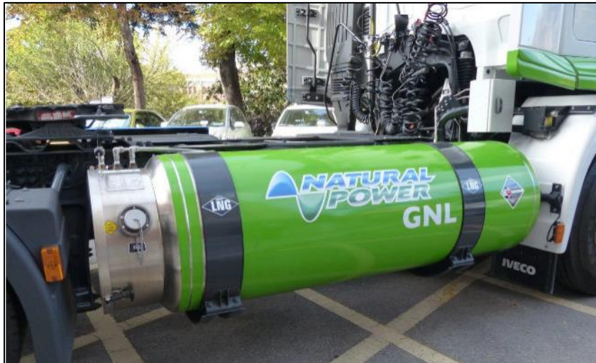
Figura 2-11. Depósito GNL camión pesado.
