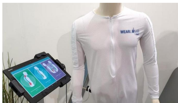
Figura 7. Camiseta Wearlumb junto con una tablet en la que se muestra la aplicación donde se registran y visualizan los datos. [16]
