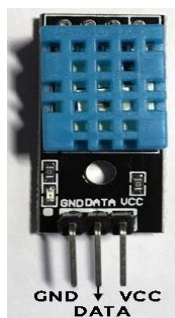
Figura 44. Pines del sensor DHT11 con la PCB. [23]
