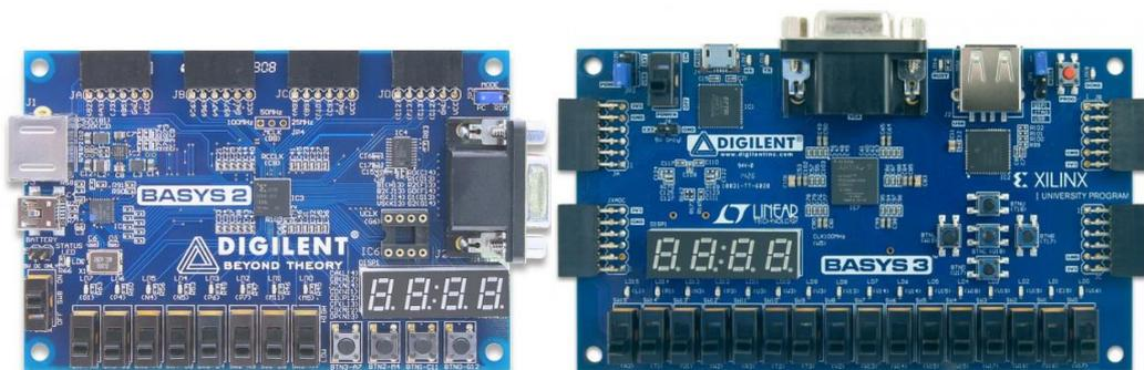
Figura 3. Placas basadas en programación FPGA
