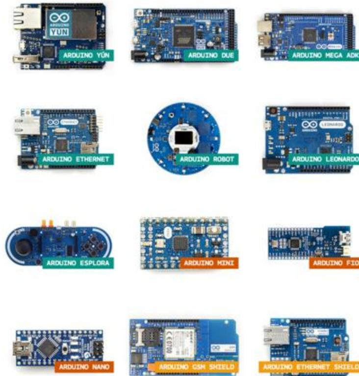
Figura 2. Diferentes placas ARDUINO
