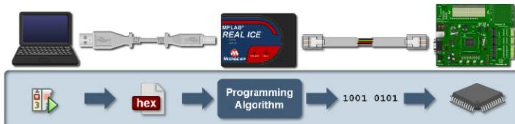
Figura 9. Programador/Depurador trabajando como Programador
