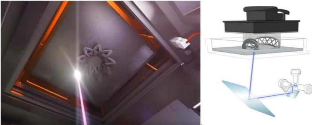
Figura 38: Solidificación de la resina en la placa de impresión y esquema de funcionamiento de la Form2
