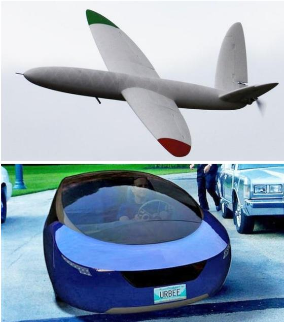
Al margen del mundo de la aeronáutica, de la mano de Kor Ecologic, se presentó el primer prototipo de coche cuya carrocería fue 100% impresa en 3D, contaba con un motor híbrido, tres ruedas y era capaz de alcanzar los 110kmh.
