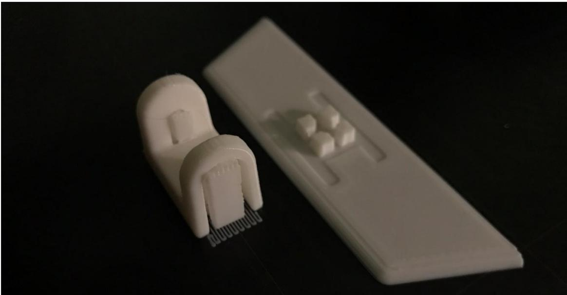
Figura 94: Prueba de impresión con los soportes adheridos.
