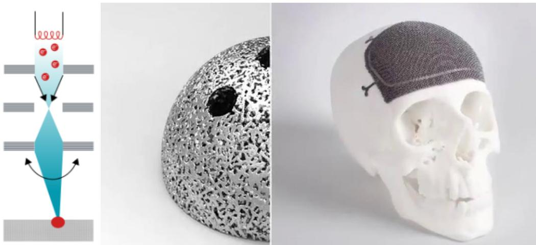
Para asegurar el correcto funcionamiento de la proyección del haz de electrones, todo el proceso se realiza al vacío. Esto también permite evitar que el polvo se oxide durante el calentamiento, de esta forma, al final de la fabricación, una gran parte del polvo no fundido es reutilizable casi
