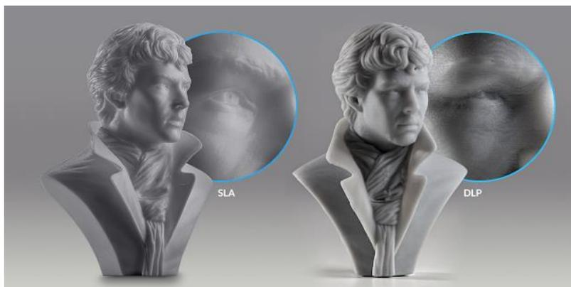
Como se observa en la imagen, la tecnología SLA obtiene un mejor acabado, ya que permite trazar formas redondeadas y continuas. Sobre el modelo impreso mediante DLP, se pueden apreciar las líneas correspondientes a las capas de impresión. A pesar de ello, ambas tecnologías logran una resolución muy superior a las impresoras que utilizan el moldeado por deposición fundida (FDM).
