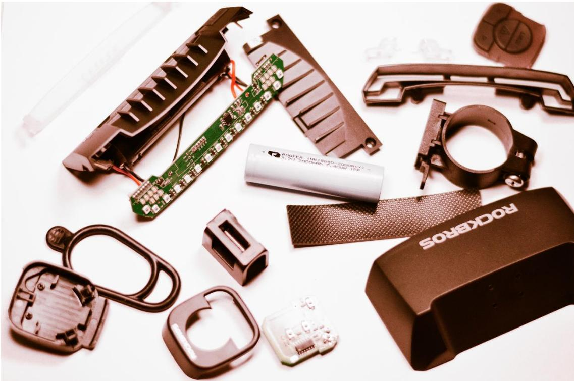
Figura 7: Despiece del piloto del fabricante RockBros
