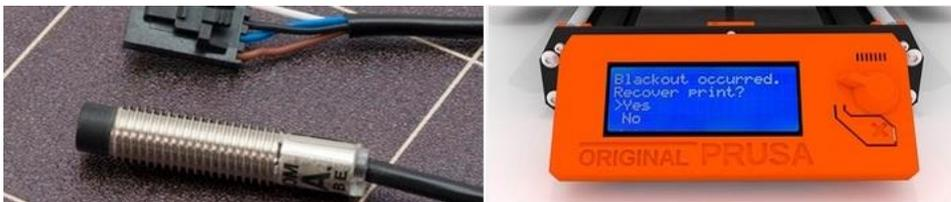
Figura 35: Sonda P.I.N.D.A 2 y pantalla en modo Pánico
