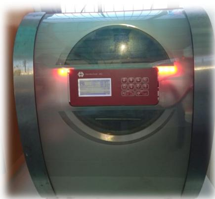
**Figura 4.** Autoclave de vapor SHP Steriltechnik LABOKLAV (25 MV).
