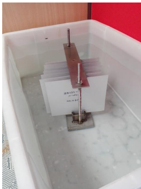
Ilustración 21. Muestras sumergidas en el agua destilada
