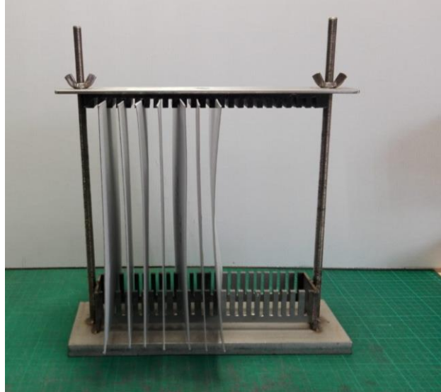
Ilustración 20. Disposición de las muestras sobre el soporte antes de ser sumergidas
