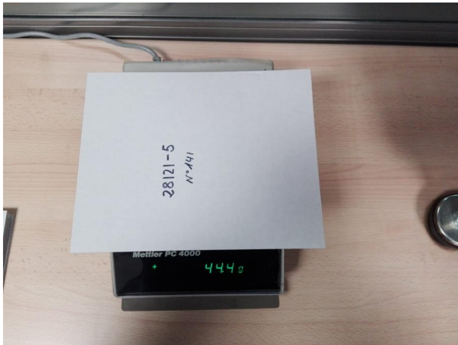
Ilustración 18. Determinación del peso de la muestra de 25 x 20 cm
