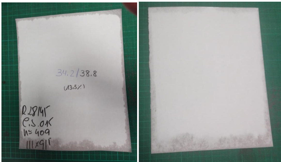
Ilustración 24 y 25. Muestras rechazadas por marcas de agua
