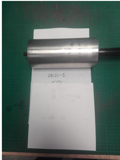
Ilustración 22. Secado de la muestra mediante el uso del rodillo y el papel secante
