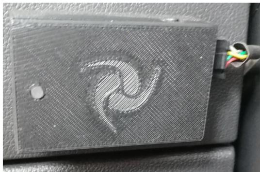
**Figura 7:** Sensor de aviso automático en caso de colisión
