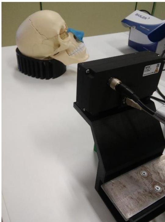
Figura 25: Disposición de trabajo para la captura de la cámara ToF.
