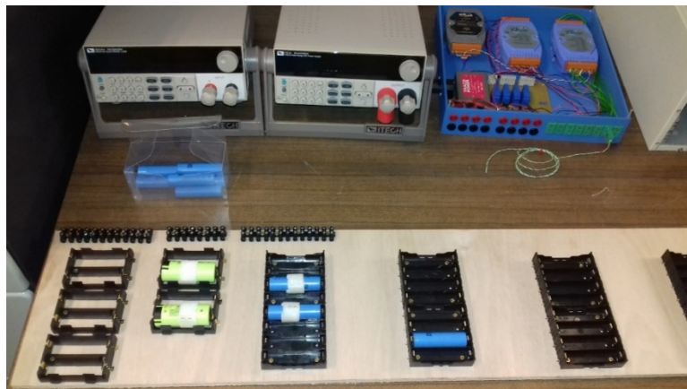
Figura 11. Portabaterías, para los tamaños 26650 (izquierda) y 18650 (derecha).
