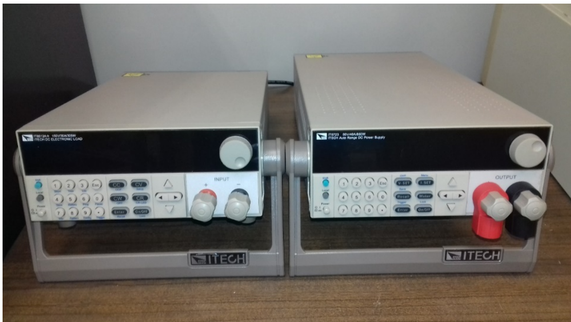
Figura 8. A la izquierda carga electrónica IT8512A+. A la derecha, fuente de alimentación IT6723
