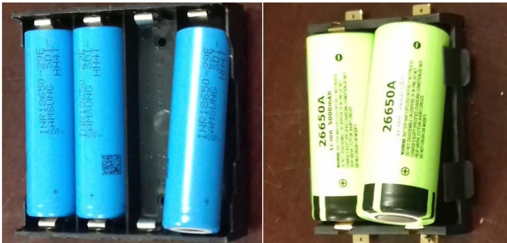
Figura 7. Baterías de iones litio adquiridas. A la izquierda baterías tipo A de 2850 mAh, a la derecha de tipo B de 5000 mAh.
