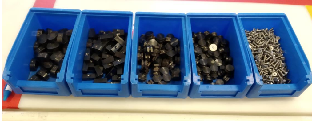
Ilustración 3.13 Bacs con los cuatro tipos de insertos (en orden: ovalados, rectangulares, hexagonales y circulares) y con tornillos
