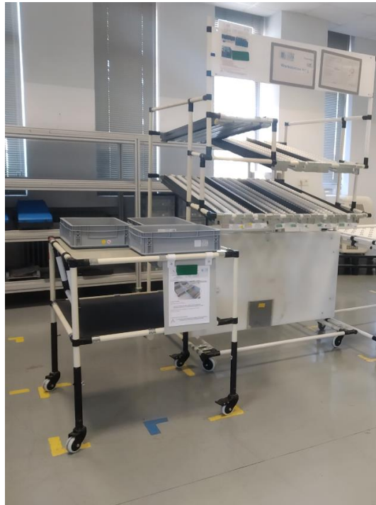
Ilustración 3.49 Mesa con bases mecanizadas en la entrada de la línea de montaje
