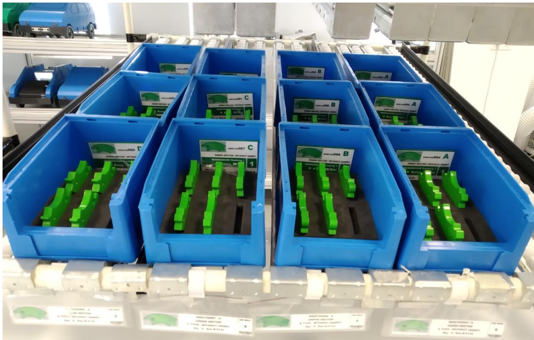
Ilustración 3.68 Puesto uno de montaje con el material correspondiente
