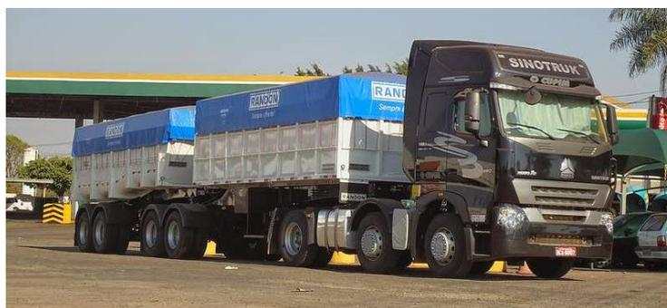
Ilustración 3.12 Camión B-doble brasileño - <https://www.motorpasion.com>
