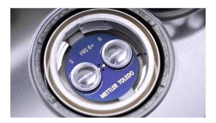
Figura 17: Celda del calorímetro Mettler Toledo 822e donde se coloca la muestra y la referencia.
