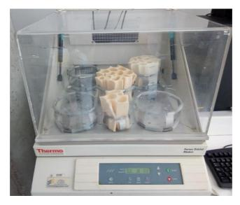
Figura 16: Incubadora con agitación orbital.
