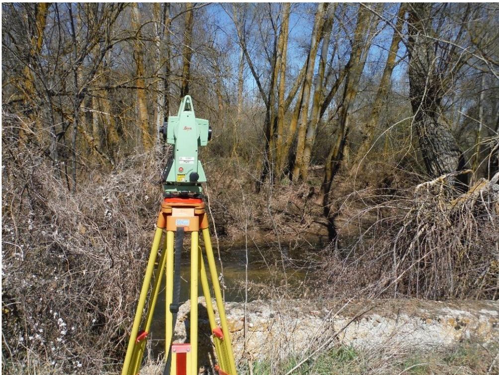
Figura 13. Estacionamiento de la estación total LEICA TC307 sobre la ODT.
