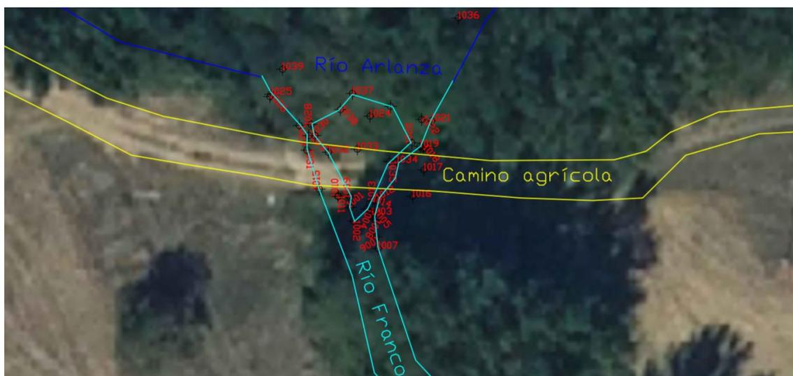
Figura 3. Esquema del levantamiento topográfico realizado sobre una ortofoto.
