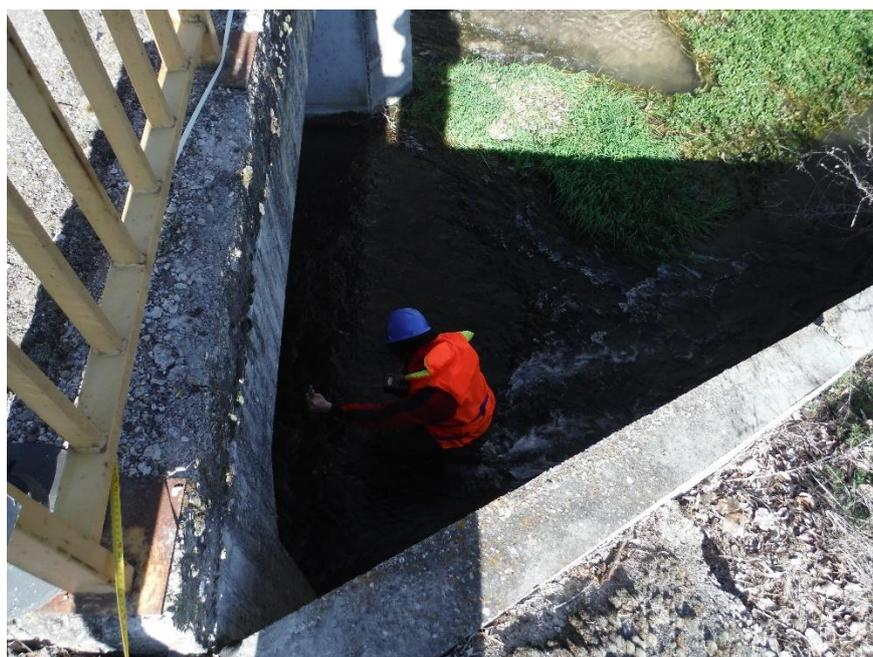
Figura 5. Medición de la velocidad en una de las secciones del puente.
