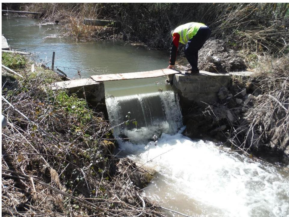
Figura 11. Medición de la carga de vertido (h) sobre el vertedero.
