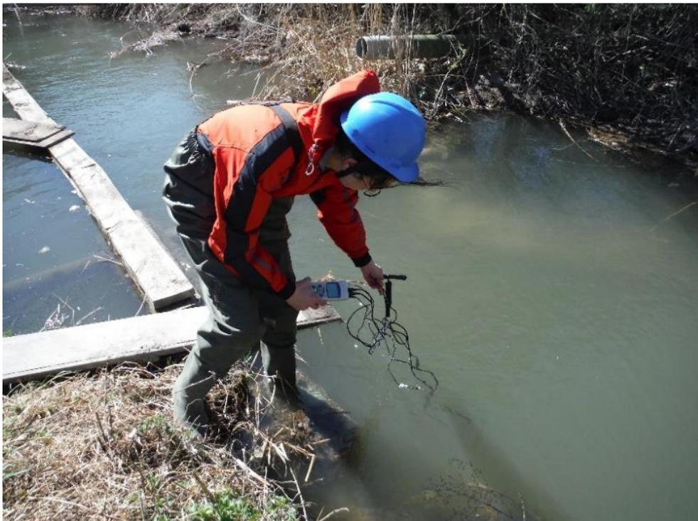
Figura 14. Medición de parámetros fisicoquímicos mediante el PCE-PHD1.
