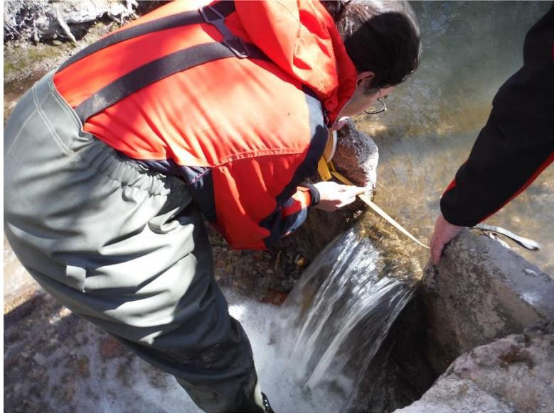
Figura 9. Medición de la anchura (b) de uno de los vertederos.
