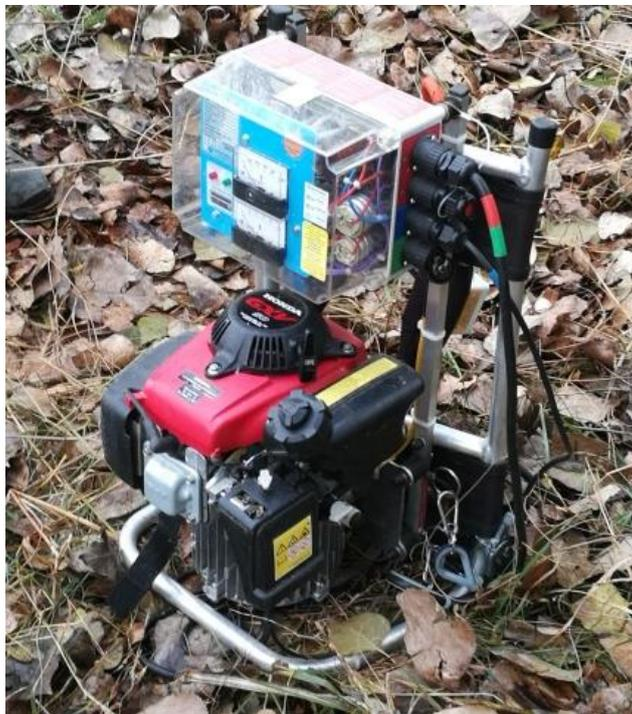
Figura 10. Generador de corriente y transformador.
