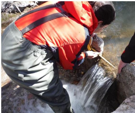
Figura 12. Medición de un vertedero.
