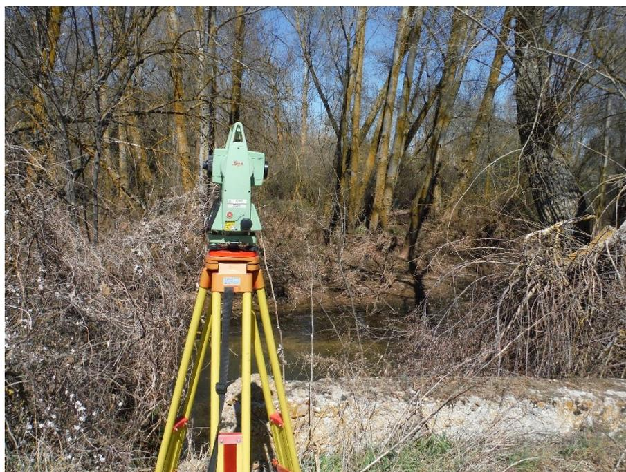
Figura 1.2. Estacionamiento en campo del modelo LEICA TC307.
