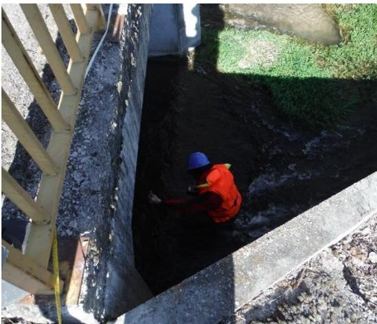
Figura 11. Aforo con velocímetro.
