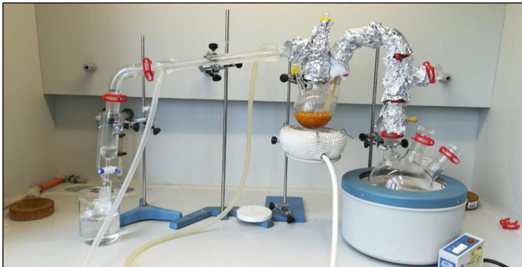
Figura 51. Montaje de la extracción de arrastre por vapor.
