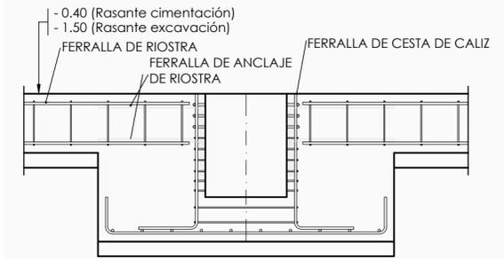
**SECCION TIPO ZAPATA CON ARMADURA DE PUNZONAMIENTO**
