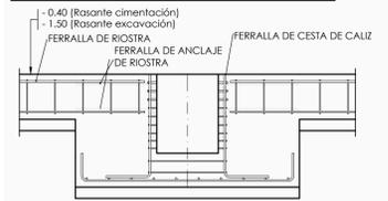
**SECCION TIPO ZAPATA CON ARMADURA DE PUNZONAMIENTO**
