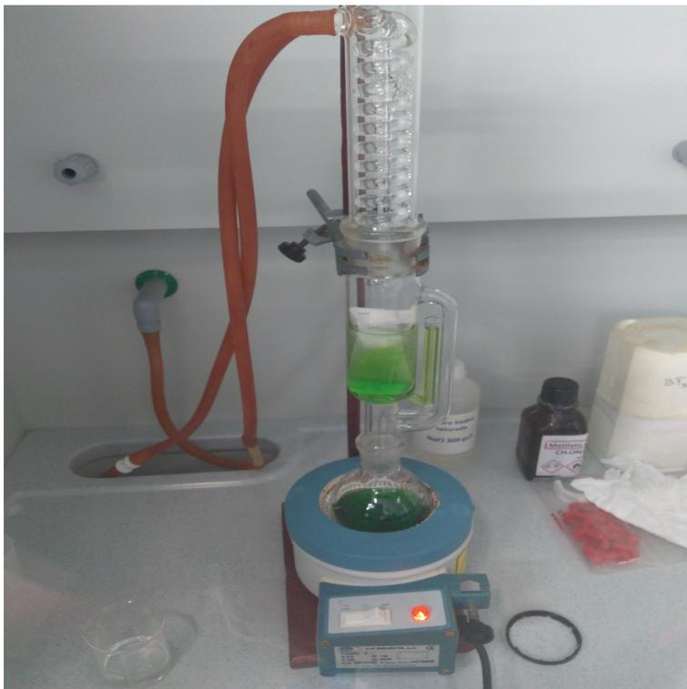
Figura 4.2: Extracción mediante Soxhlet de la muestra
