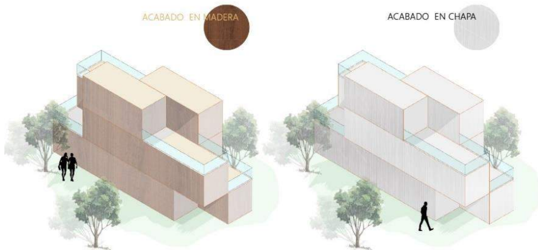
Viviendas con containers con diferentes acabados
