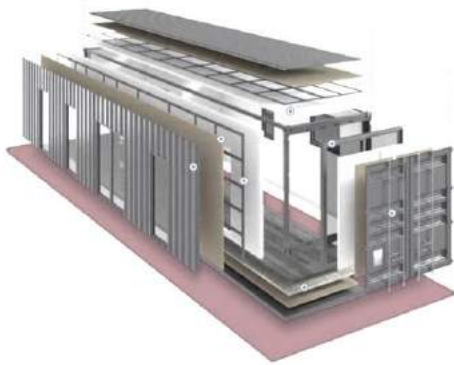
Aislamiento térmico en una vivienda container
