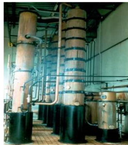
Anexo 1. Figura 4: Sistema de columnas.
