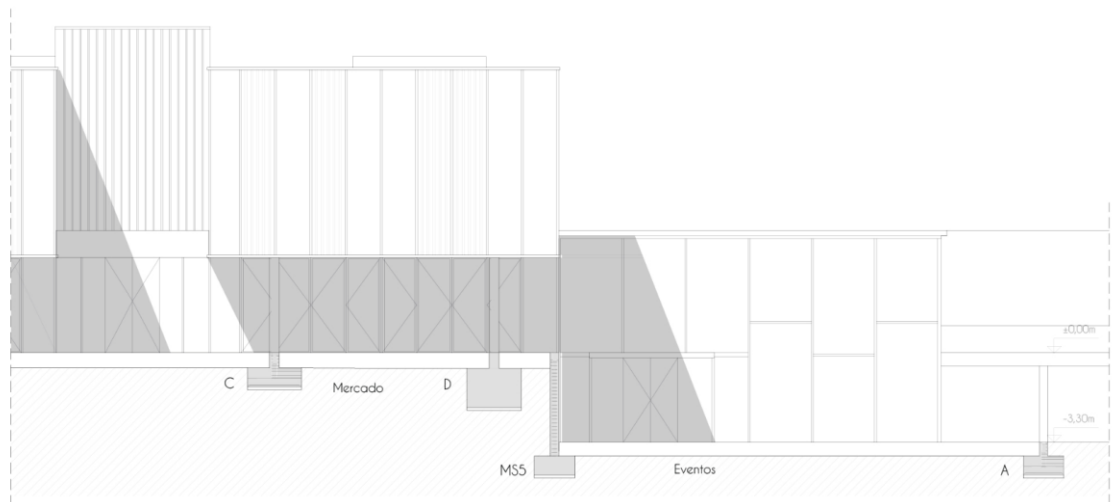
Cimentación en la zona de Mercado (izq.) y eventos (dcha.) más cercana a la ribera
