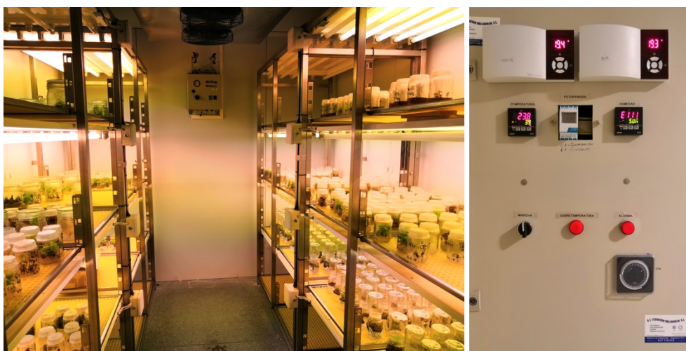
Figura 3. Instalaciones utilizadas para el crecimiento de los cultivos in vitro de este proyecto (izq.). Detalle del cuadro de mandos de la cámara de cultivo in vitro (der.).
