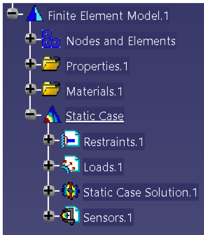
Figura 2. Estructura del árbol del modulo Generative Structural Analysis.
