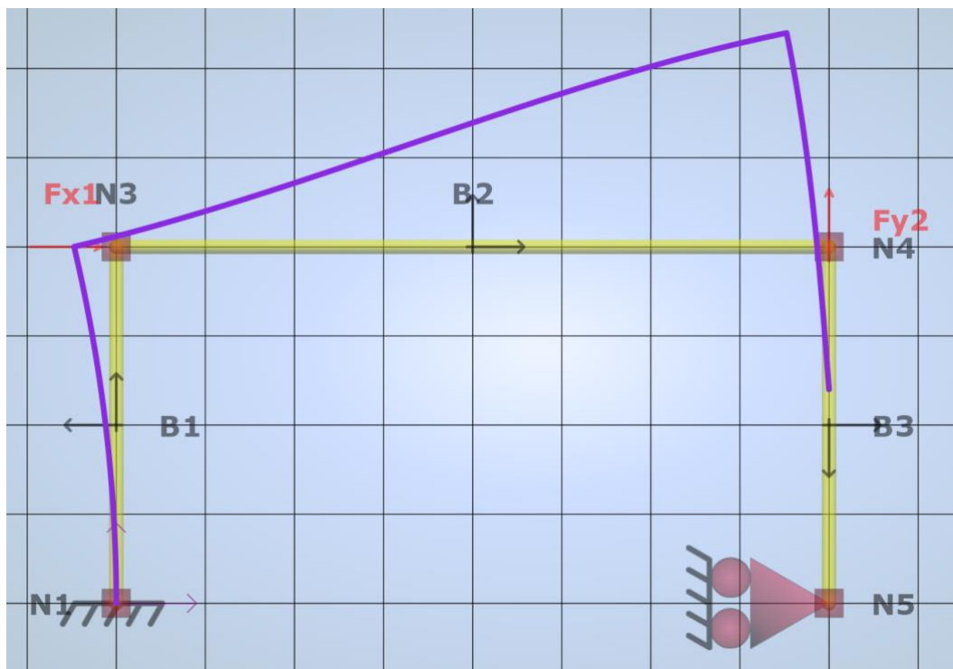
Figura 141. Deformada del pórtico en MdrFX.
