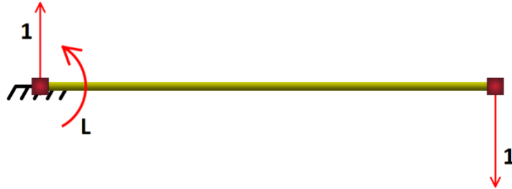
Figura 51. Viga en voladizo sometida a una carga puntual.
