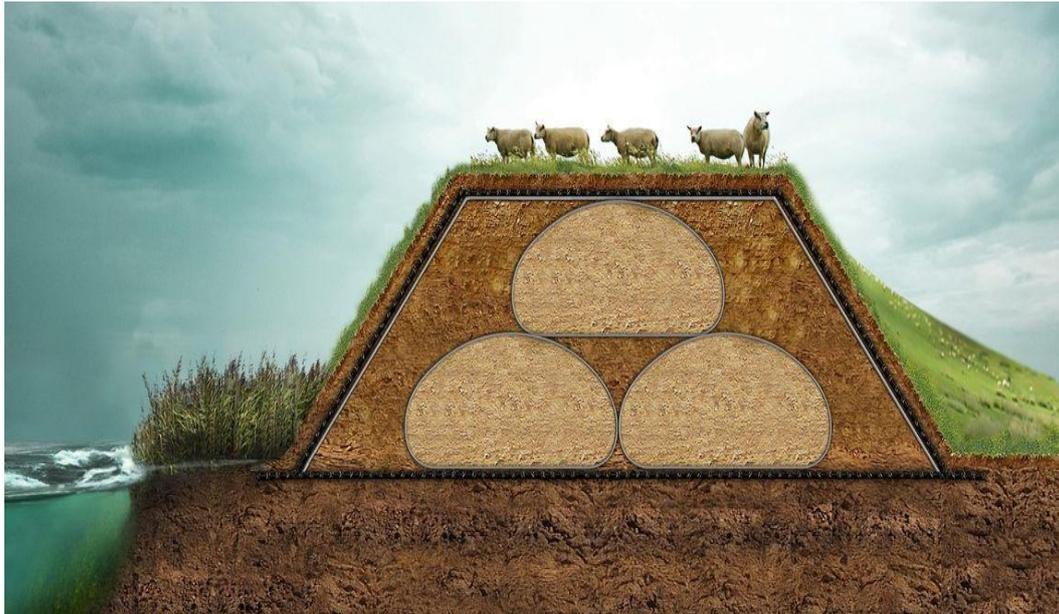
Imagen 10: sección de dique de contención contra inundaciones. El río se sitúa a la izquierda.
