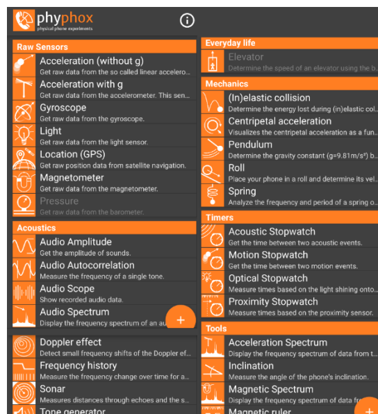
Figura 2 Menú principal de la aplicación phyphox. Las funciones Pressure y Elevator no están disponibles en este caso, porque el móvil no dispone de barómetro
