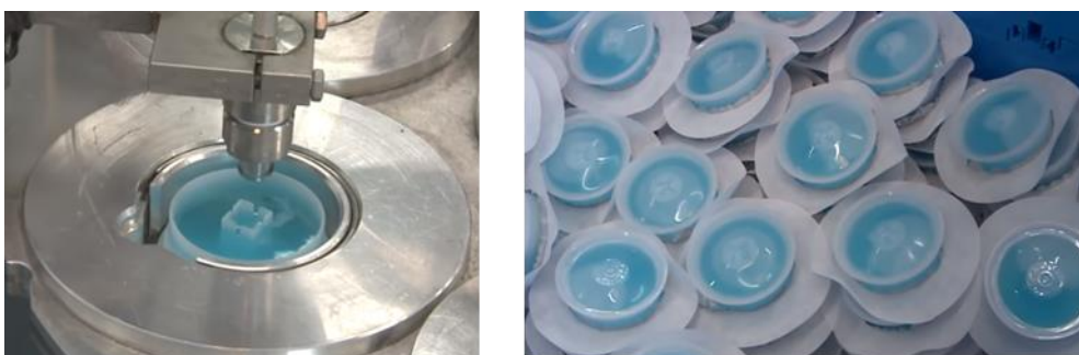
Figura 19. Máquina para el llenado de las cápsulas de agua coloreadas. Fuente: página web oficial de la empresa
