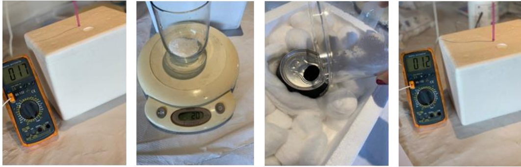
Figura 13. Procedimiento experimental para la determinación de la entalpía de disolución. Fuente: elaboración propia
