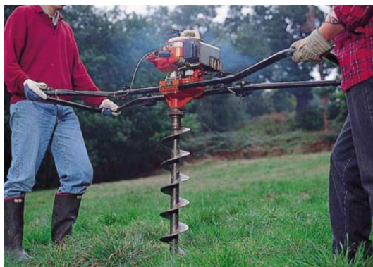
Ilustración 12: Ahoyador mecánico trabajando. Fuente: Imagen extraída de internet.
