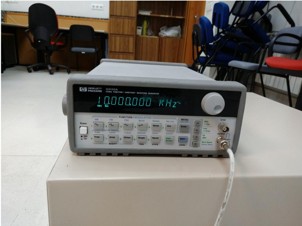
Figura 3.8.: Generador de señales.
