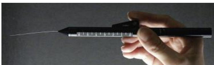
Figura 3. Estesiómetro de Cochet-Bonnet. 10
